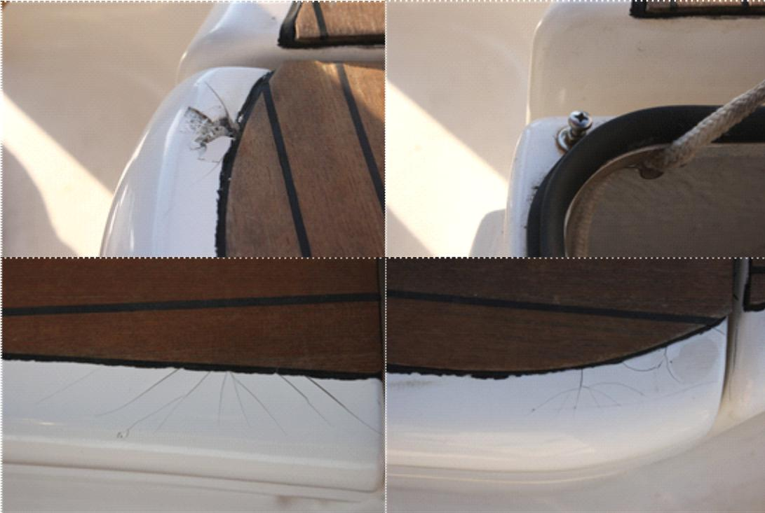
Harry treibt eine Wartungsfirma auf, die den Schaden im Laufe des Tages beheben wird. Auch das im Seegang abgerissene Klobrellenschanier wird ersetzt.
